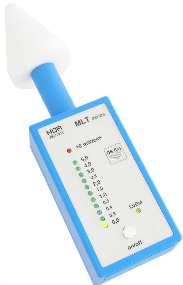
Das Modell MLT 5 ist ein modernes Testgerät zum Auffinden von Mikrowellenfeldern. Die einfache Handhabung gibt Sicherheit im Umgang mit Mikrowellenquellen. Als konsequente Weiterentwicklung des MLT 4 vereint es die bewährte, einfache Bedienung mit den Möglichkeiten der modernen Technik.
